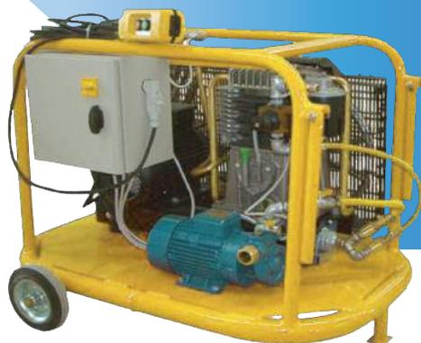
**RAUZI GER 600** es un generador continuo de espuma a utilizar en el aligeramiento de mezclas de cemento.
