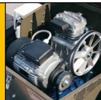
Compartimiento motor - compresor
